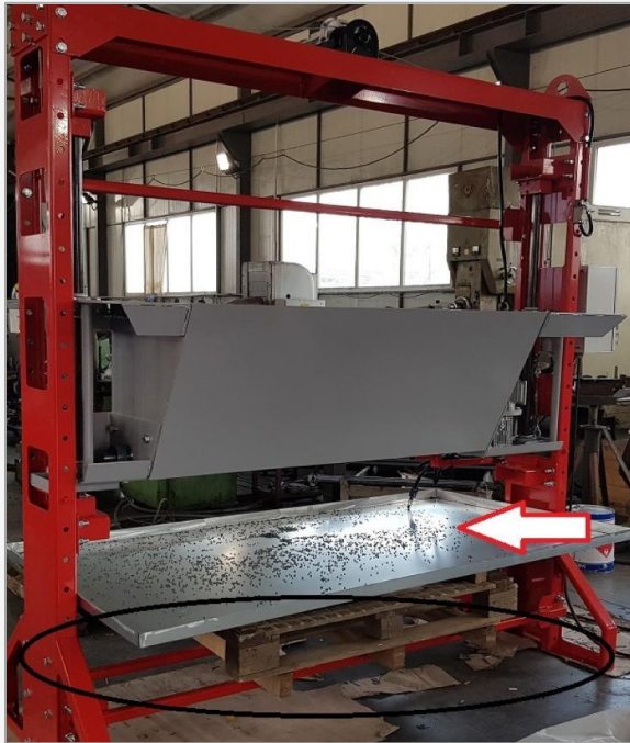
Хоризонтални греди за стабилност и защита от деформация, събирателна тава за излишния материал
