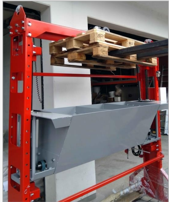
Повдигайте дозиращото устройство само за хоризонталните пръти или за ушите на крана
